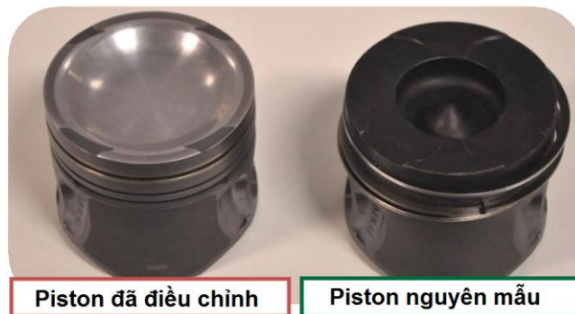
Hình 2.8: Thay đổi tỷ số nén thông qua thay đổi hình dạng đỉnh pittông [16].
